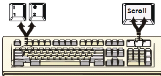
Figura 12: Seleção específica de canais através da chave de atalho
