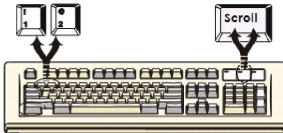
Figure 12: «горячие» клавиши выбора отдельного канала
