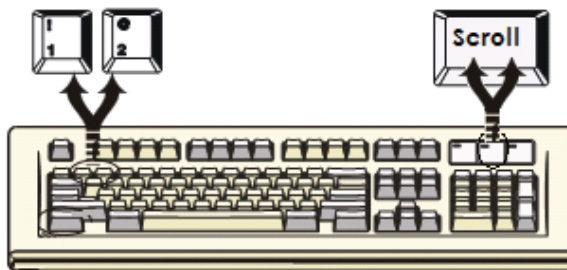
Figura 12: Tecla caliente de selección de canal específico
